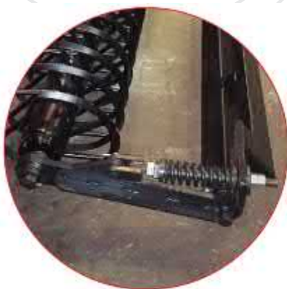
Пружинно-винтовой механизм опоры катка , для контроля глубины на любых углах атаки
