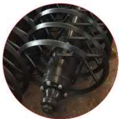
Спиральный опорный каток с пространственным гибом для эффективной сепарации почвенного комка
