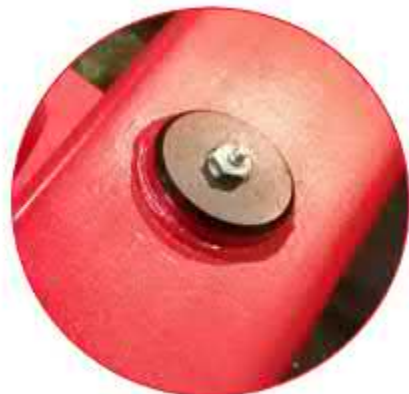
Масленка в каждой стойке - позволяет значительно уменьшить время необходимое на обслуживание
