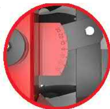
Регулировка угла Атаки от 15 до 30 градусов
