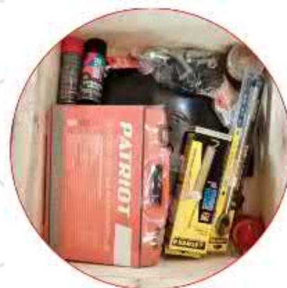
Ящик для ЗИП - с необходимыми для запуска и эксплуатации запасными частями: диск 2 шт, шприц, литол, перчатки, болты, крышки, гайки, пальцы, съемник стопорных колец, стопорные кольца.
